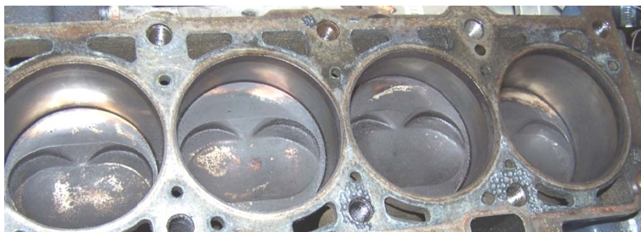
Рисунок 7 Внешний вид камеры сгорания со стороны блока цилиндров после работы двигателя на топливно-водной смеси
