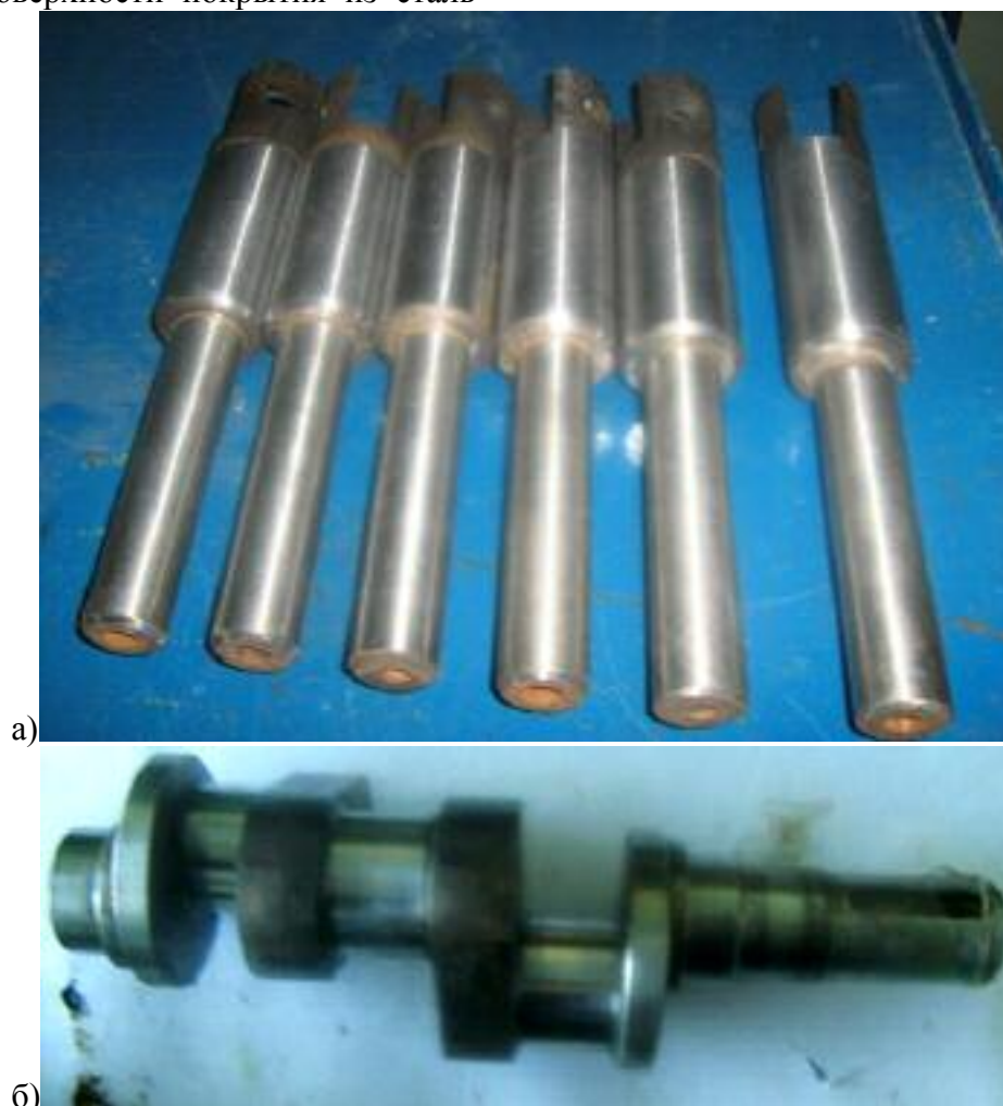
Рисунок 3 Детали моечной машины, восстановленные электроконтактной приваркой стальной ленты: а) – плунжеры, б) – коленчатый вал.
