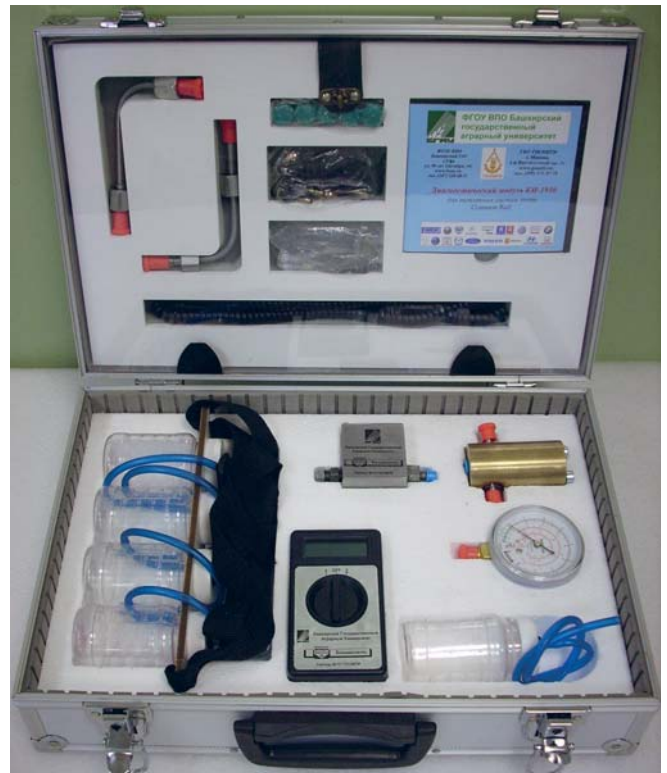
Рис. 1. Общий вид диагностического модуля КИ-1950
