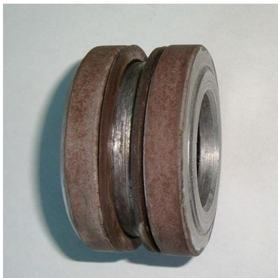
Рисунок 5.3 – Поршень гидроцилиндра Ц-75 восстановленный и упрочненный за счёт применения комбинированной технологии МДО с последующим модифицированием МДО-покрытия частицами нанопорошка  $\text{CuO}$
