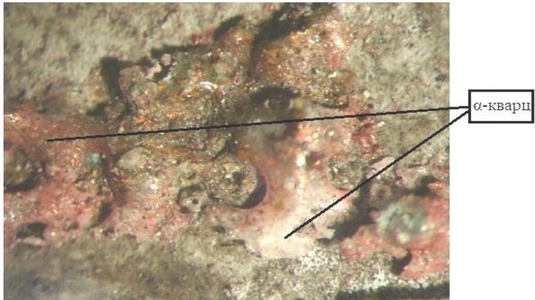
Рисунок 4.3 – Образование диоксида кремния ( $\alpha$ -кварца) на поверхности МДО-покрытия при вторичной обработке,  $\times 25$
