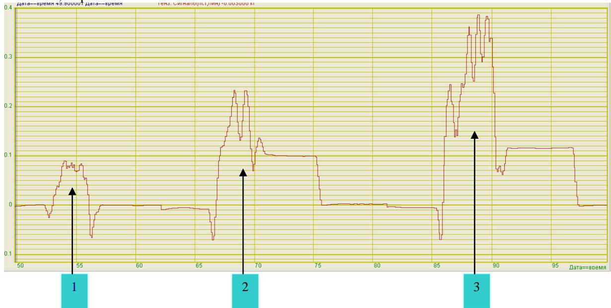
Рисунок 4.5 – График изменения общего коэффициента трения для пары трения «сталь 40X – МДО-покрытие» в зависимости от нагрузки, где результаты измерений соответствуют: 1 – при 125 Н; 2- при 240 Н; 3 – 340 Н
