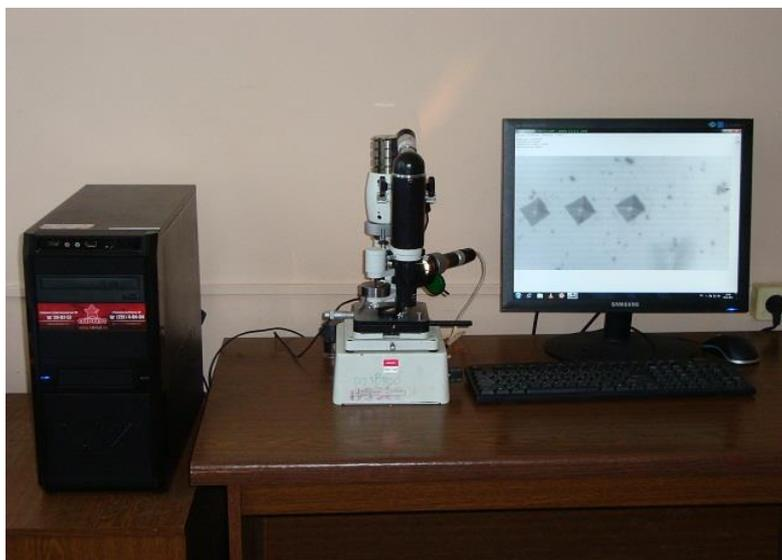
Рисунок 3.4 – Общий вид компьютеризированного микротвердомера ПМТ-3М-01
