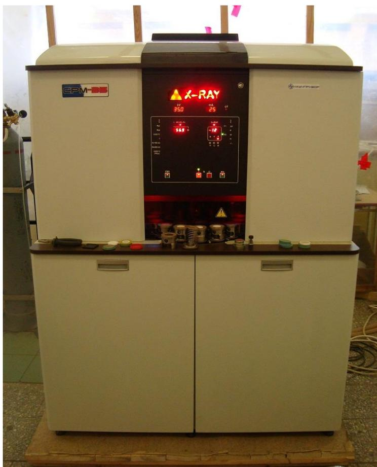
Рисунок 3.5 - Общий вид многоканального рентгеновского спектрометра СРМ-35
