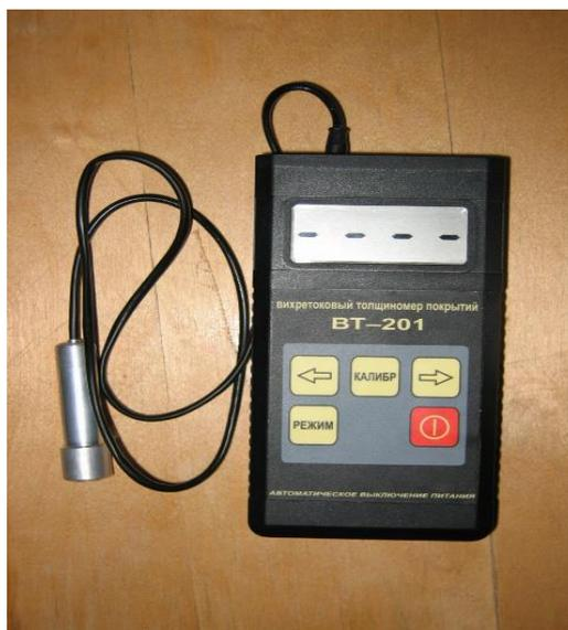
Рисунок 3.3 – Вихретоковый толщиномер ВТ-201
