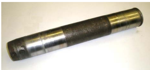
Рисунок 1 Изношенный палец стрелы экскаватора
