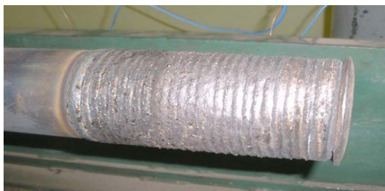
Рисунок 2 Палец стрелы после наплавки
