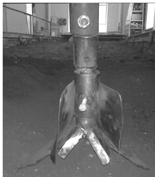
Рисунок 1 – Экспериментальный комбинированный сошник с изменяющимися параметрами
