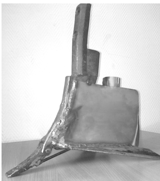
Рисунок 1 – Экспериментальный комбинированный сошник с изменяющимися параметрами
