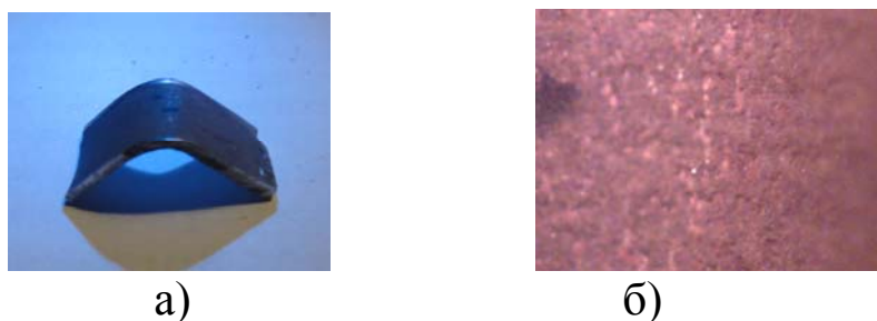
Рис.3. Внешний вид образца (а) и место сгиба (увеличение 60 раз) (б)
