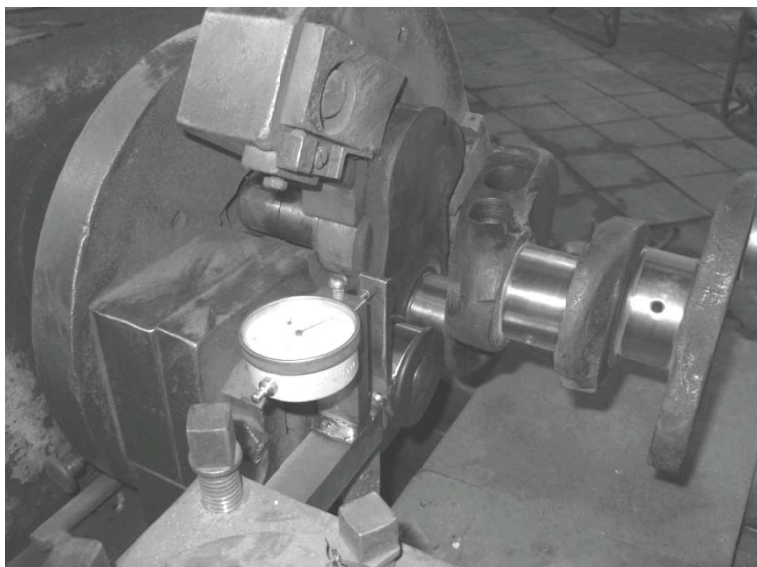
Рисунок 3 Приспособление для обкатки галтелей шатунных шеек восстановленного коленчатого вала
