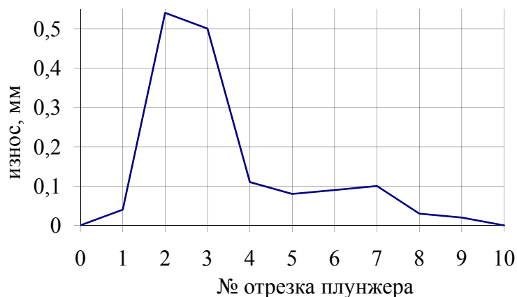
Рисунок 3 График износов образца №51,4
