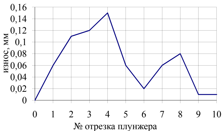
Рисунок 2 График износов образца №53,2
