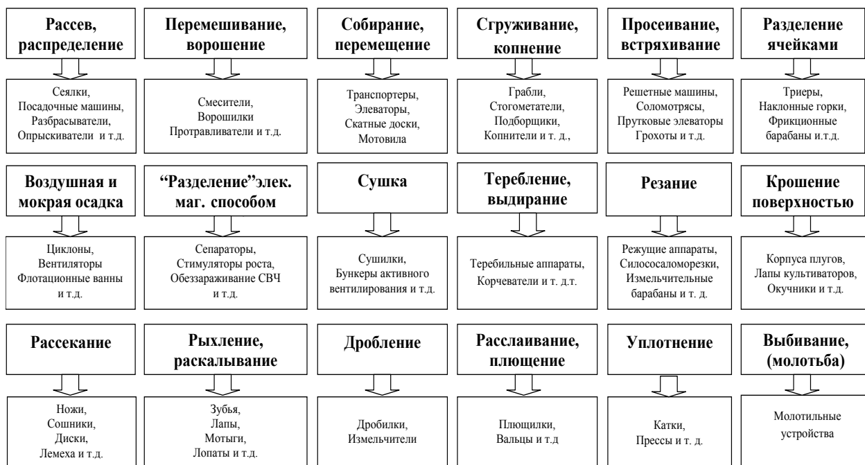
Рисунок 1. Каталог классов технических объектов механизации сельскохозяйственного производства (по В.П.Горячкину)
