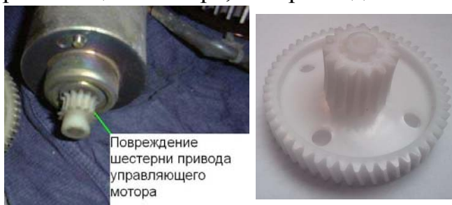
Рис. 2 – Изношенная шестерня управляющего мотора и ее замена
