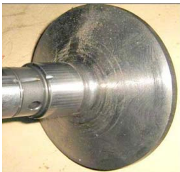
Рис. 1 – Изношенный шкив вариатора
