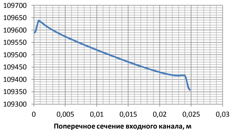
Рисунок 4 Эпюра давления на входе во втором смесителе
