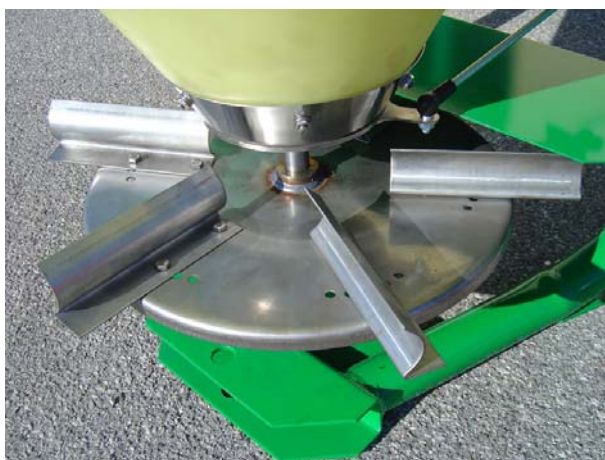
Рисунок 1 Диск разбрасывателя минеральных удобрений
