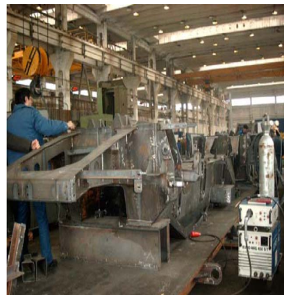
Рисунок 1 Сварка рамы автомобильного крана грузоподъемностью 80 т
